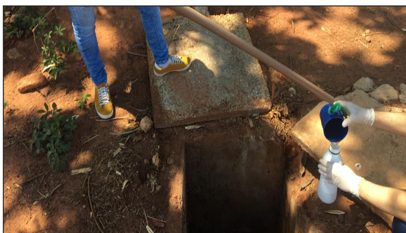
Figura 2 – Coletor desenvolvido para as coletas de esgotos na ETE 1 da UFCA – Campus Juazeiro do Norte – CE
